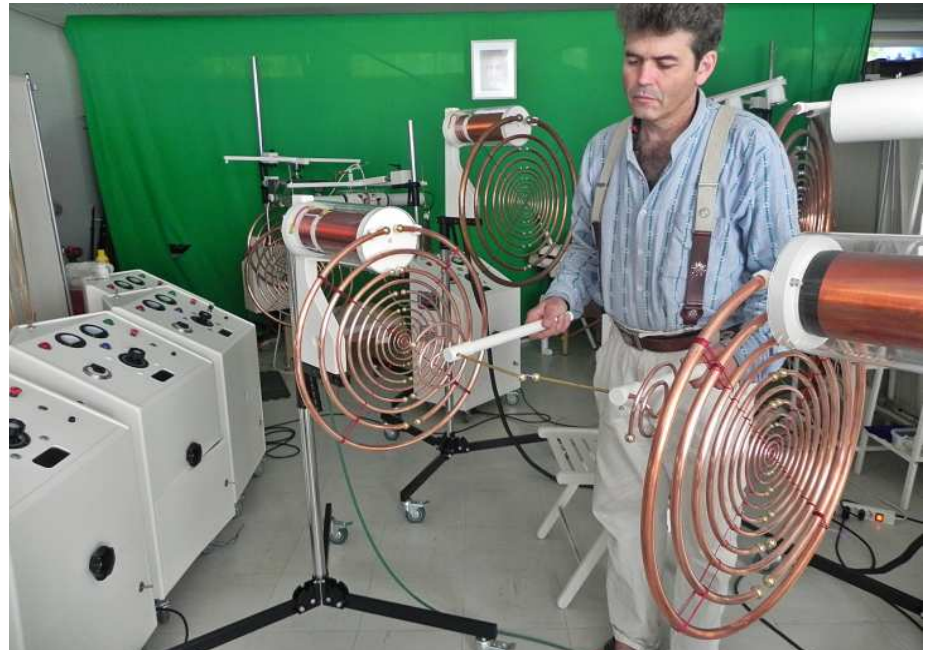
Heinz Tobler zeigt, wie zwischen den kleinen Kugelelektroden aufgrund des induzierten elektrischen Feldes zweier Induktionsspulen helle Funken überspringen.
