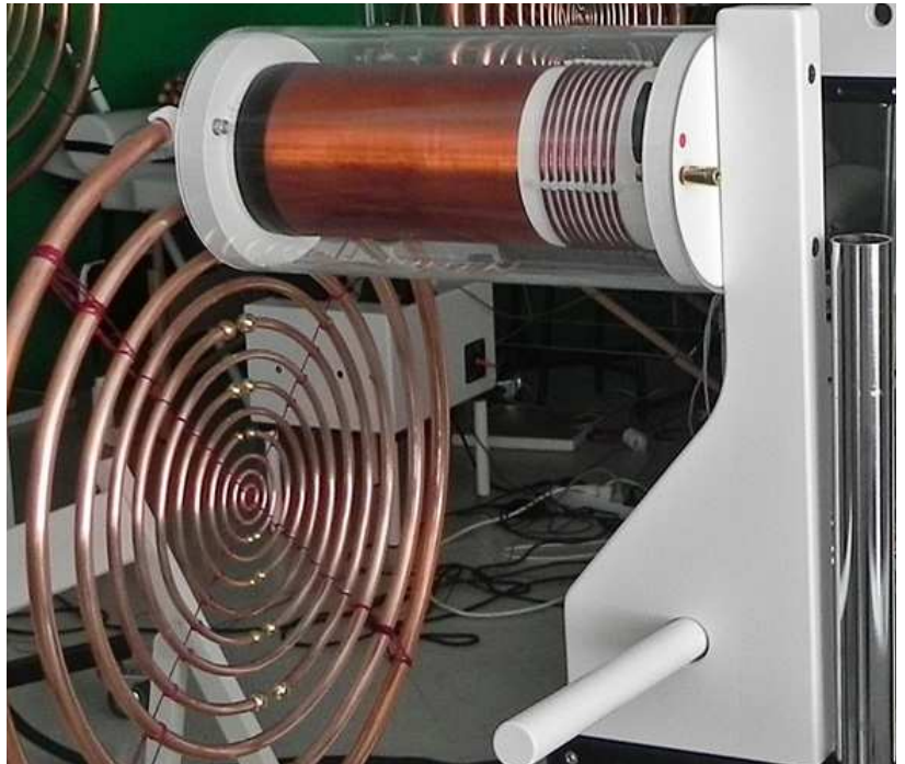
In der oben sichtbaren Plexiglasröhre ist ein Tesla-Transformator angeordnet, der auf der rechten Seite eine Primärspule mit wenigen Windungen aufweist und auf der linken Seite eine Sekundärspule mit sehr vielen Windungen besitzt.
